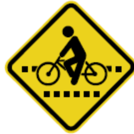
Figura 14 – A-30b – Passagem sinalizada de ciclistas
