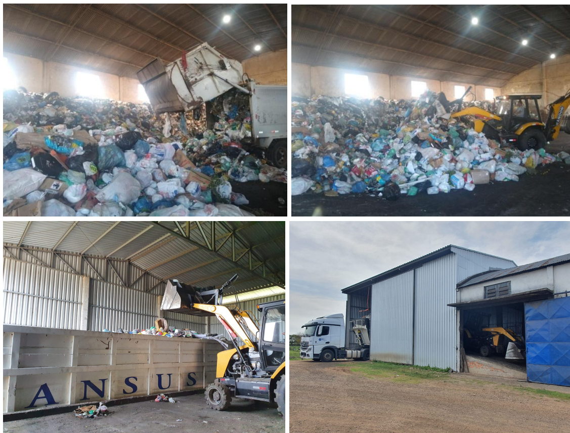
Figura 11: Recebimento e manejo dos resíduos junto à unidade de Transbordo.
